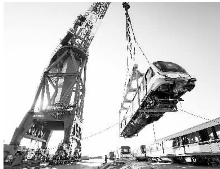
2014年,辽宁营口港累计装运出口地铁车厢300多节,同比增长一倍以上。图为一批由我国北车集团制造、出口新加坡的地铁车厢在辽宁营口港装船外运,营口港工人指挥门座式起重机吊起地铁车厢。
