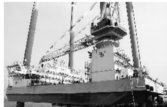
青岛海西重工研制的我国第一个四腿艇自升式多功能海洋生活平台,能容纳150人在上面生活,设备国产化率达到90%。 本报记者 杜铭摄
