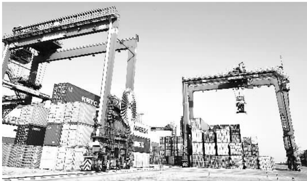
在全国石材最大输入港——泉州石狮市石湖港,变燃油为电能驱动的起重机在作业。
