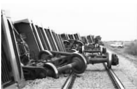
▲大风可造成列车脱轨、晚点,破坏铁路基础设施。
