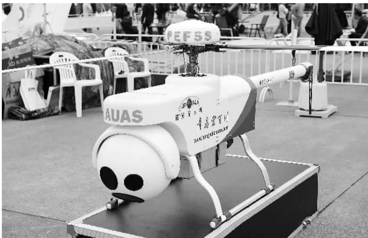
这是青岛企业自行研发制造的曙光5-A-01伞降民用无人直升机,该无人机使用独特设计的“降落伞应急故障安全系统”,遇到突发事件时可有效实现无人机伞降。 新华社 梁旭摄
