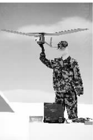
这是彩虹902(CH-902)便携式小型无人机系统,采用单人手抛方式放飞,可执行对地面目标的空中侦察任务,也可担负反恐、交通路况监视、气象环境监测等保障任务。 新华社 梁旭摄
