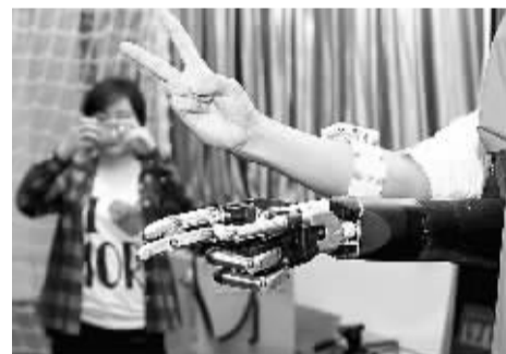
上海交大机器人研究所研发的仿人假肢手,通过创新研制的肌电臂带控制,可复现人手90%左右的动作。新华社 刘颖摄
