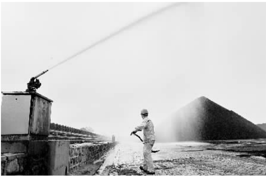
工人在黄骅港煤炭港区药剂抑尘喷淋场地内忙碌(10月6日摄)。2010年以来，黄骅港投入巨资治理煤灰污染，提升港区环境质量。新华社记者 车宇摄
