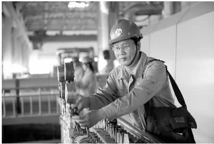
图为鲁运在检查润滑油压开关。
