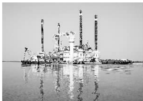
7月16日,“海恩1号”液压步进梁式海上升起平台缓缓驶离渤海湾,奔赴胜利油田服役。这是我国自主研发的首台移动式海洋钻井平台。
