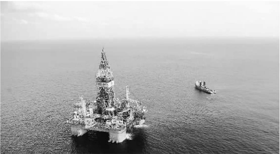
右图：“海洋石油981”是我国自主设计、建造的第六代3000米深水半潜式钻井平台，代表了海洋石油钻井平台技术的最高水平。
