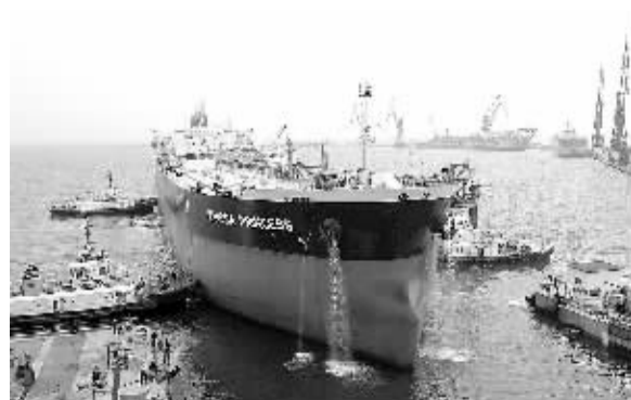
7月6日,由油轮改成的海上浮式储油船“玛诺拉公主”号出坞离港。该船集油气储存、外输、装卸、动力供应为一体,在海洋石油领域具有良好的市场前景。
