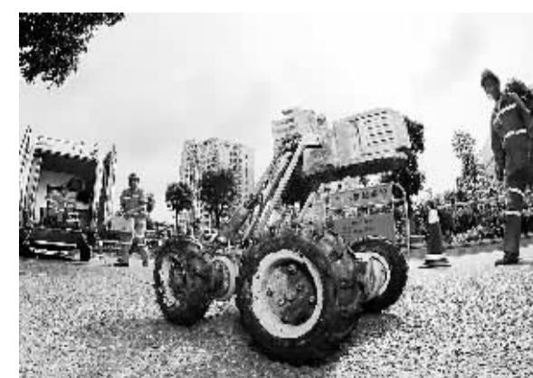
6月20日，在福建省泉州市刺桐路，机器人在工作人员的操作下移动。福建省泉州市目前已全面进入汛期，为防止发生内涝，泉州市有关部门使用带有视频系统的机器人检测地下排水管网，显著提高了工作效率。
