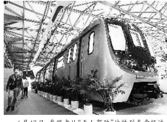
6月17日，参观者从“无人驾驶”地铁列车旁经过。当日，国内首列“无人驾驶”地铁列车在上海亮相。据介绍，该车无需司机操控，即可实现列车自动唤醒、自检、自动驾驶离站、上下坡行驶、到站精准停车。
