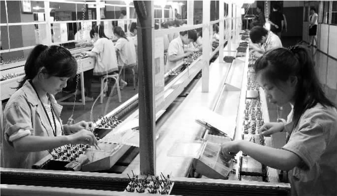
我国正在努力降低节能灯中汞的含量,目前财政补贴推广高效照明产品中的固汞含量大多数在2.5至3.5毫克之间,远低于国际标准5毫克。图为杭州宇中高虹照明电器有限公司的节能灯生产线。
