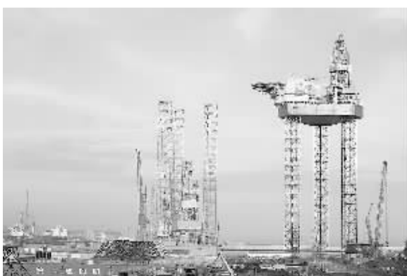
6月4日，大船重工新建成的一座400英尺自升式钻井平台JU2000E在作升降试验。该钻井平台已成为大船重工海洋工程的“拳头”产品，在国内海洋工程设计建造领域处于龙头地位。刘德斌摄(新华社发)
