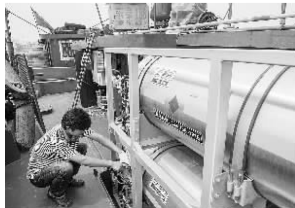
5月21日，东泰168船船主在合肥东港码头查看船上的天然气罐。当日，安徽合肥首艘“油改气”船舶交付船东使用。“油改气”项目的实施，将减轻船舶对所经流域生态环境的破坏。
