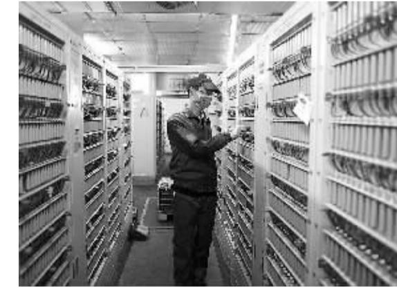
宜春福斯特有限责任公司的一位工人在检测锂电池的充放电情况。
