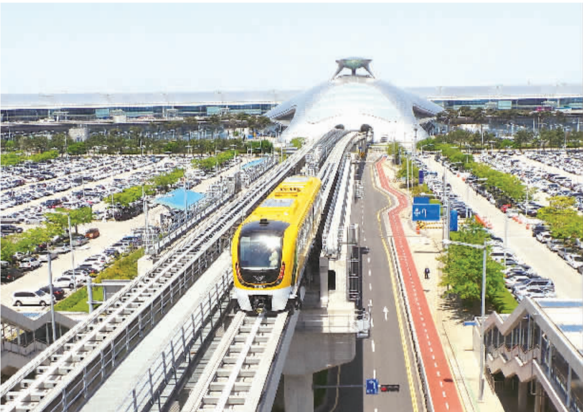
将于今年7月中旬开通运营的韩国仁川国际机场磁悬浮列车日前举行试乘仪式。该列车采用由现代ROTEM和韩国机械研究院共同研发的城市型低速磁悬浮列车技术,设计时速110千米。 本报记者 杨明援
