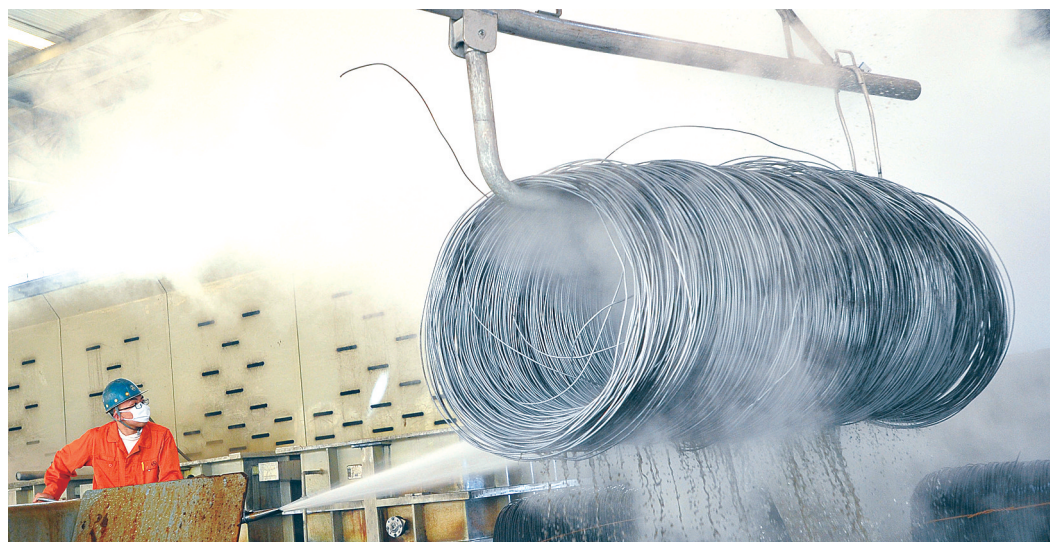
一名工人在东北特钢集团大连基地清洗合金钢线材表面氧化皮。
