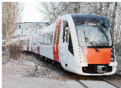
4月24日，我国首列市域快轨车辆在中国北车长春客车股份有限公司的试乘线路上运行。该款列车采用双供电制式的受电弓，并可自动切换，且为我国首次成功研发这项技术。据了解，此款快轨车最高运行时速为160公里，介于地铁车辆和城际动车组之间。
