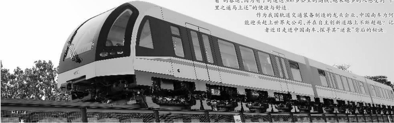
中低速磁浮列车运行在中国南车株机公司磁浮交通系统中心1.6公里的实验线路上。
