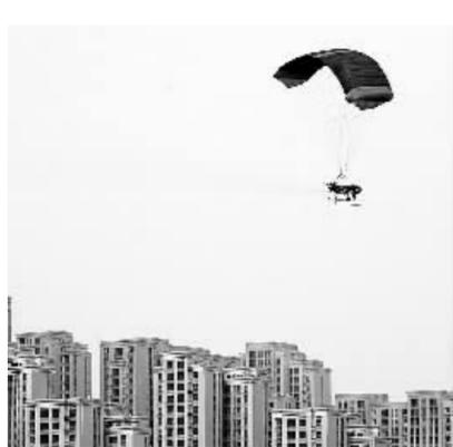
由中航工业航空救生装备有限公司研制的新型柔翼无人机人工消雾试验近日在湖北沙市机场成功完成。这款无人机是一种以冲压翼伞为机翼提供升力的低速无人机，可以自主起飞、巡航和精确着陆。图为柔翼无人机在空中喷洒催化剂进行消雾试验。新华社记者 郝向前摄
