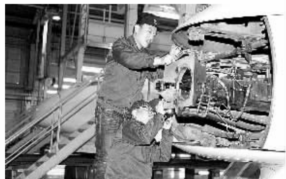
北京南动车运用所地勤机械师在检查动车组车钩。李溢春摄
