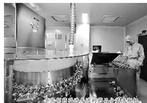
华北制药引进先进的药品分装洗瓶机。
