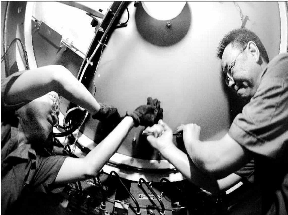
青岛经济技术开发区青岛华瑞丰机械有限公司技术人员在进行风电偏航系统制动噪音试验。该公司自主研发的国际首台在模拟实际工况状况下可进行多项测量的多功能(1:1)风力发电机偏航系统试验台，解决了制动噪音和振动等关键问题。
