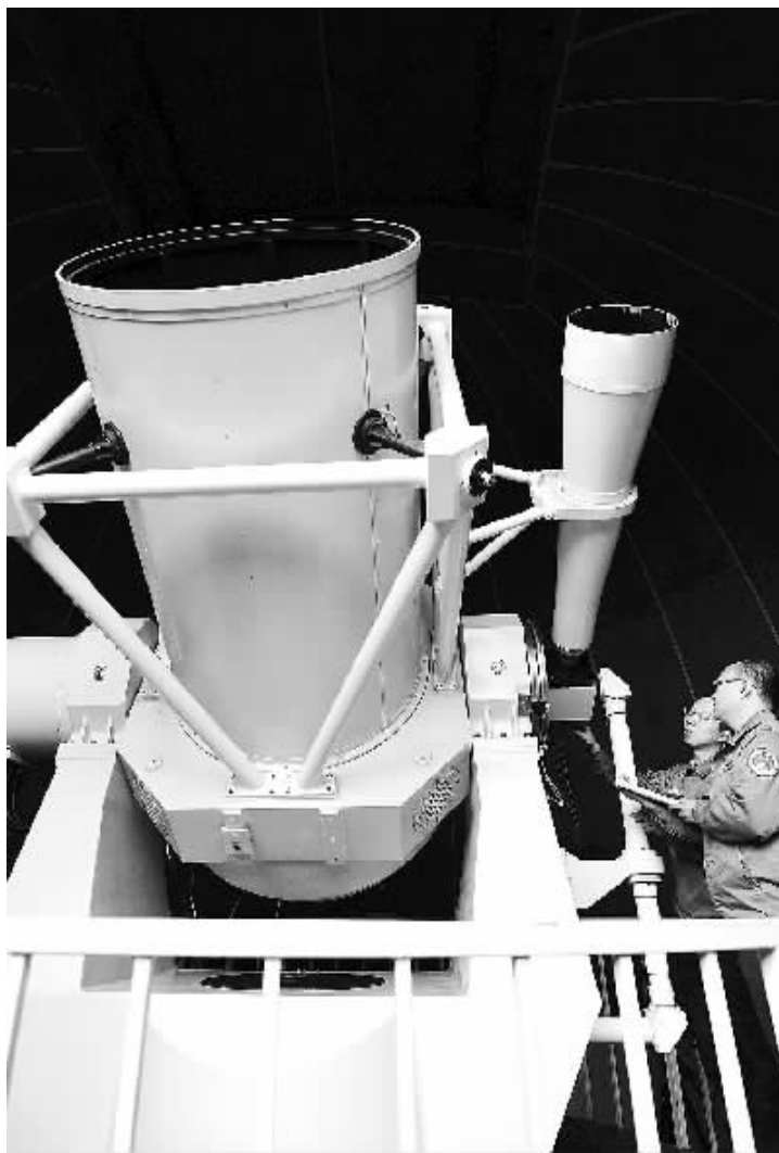
激光测距技术人员维护天文望远镜,确保系统实现白天对星观测。
