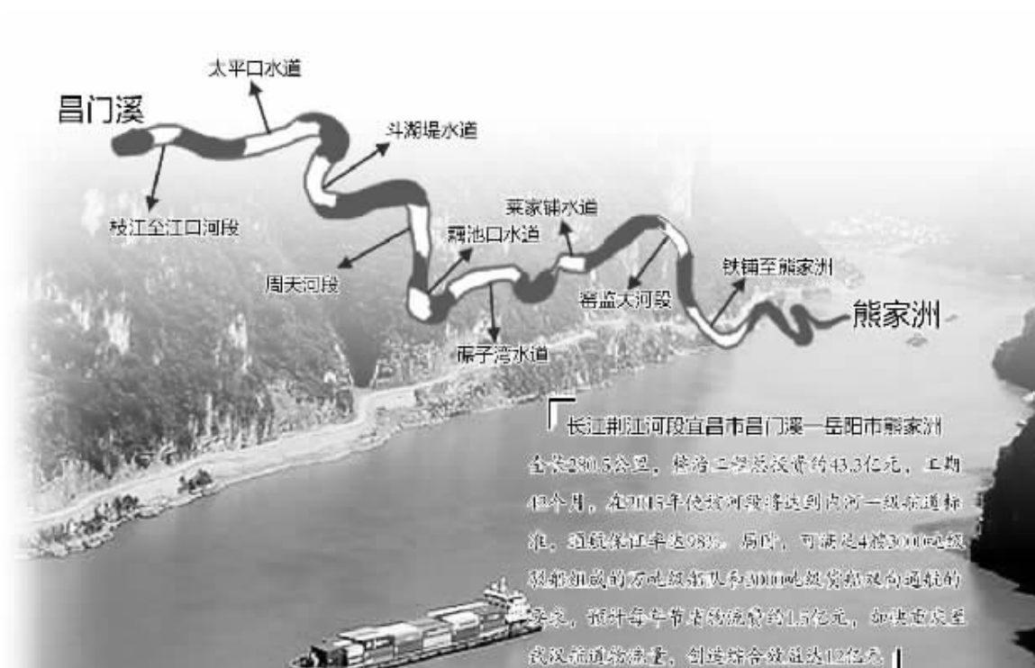
长江荆江河段宜昌市宜昌门溪—岳阳市熊家洲全长280.5公里，整治二期总投资约43.3亿元，工期42个月。在2015年使该河段将达到内河一级航道标准，通航保证率98%，届时，可满足4艘3000吨级驳船组成的万吨级船队和3000吨级货船双向通航的要求，预计每年节省物流费约1.5亿元，加快重庆至武汉货物运输量，创造综合效益达12亿元。
