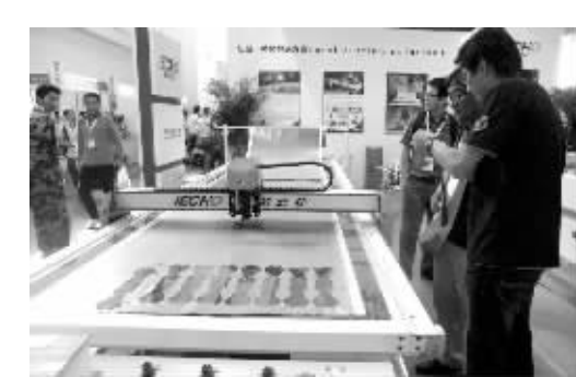
图为爱科科技有限公司自主研发生产的SC超速度国内最大幅面自动化切割系统。它具有运行速度快、精度高、稳定性强等特点,只需导入版型文件就可以自动高速剪裁碳纤维、玻璃纤维等柔性材料。 柯月摄
