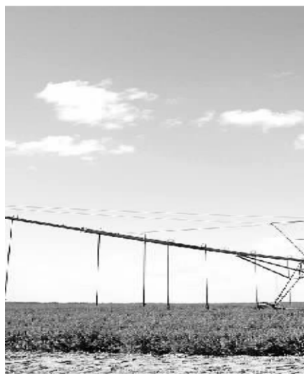
图为内蒙古赤峰市阿鲁科尔沁旗优质牧草示范基地的一套自走式节水喷灌设备。这套设备可满足500亩苜蓿地的灌溉需求。规模化苜蓿种植离不开精细化的田间管理，在沙化的草原上，阿鲁科尔沁旗利用机械化方式种植优质牧草，亩产苜蓿可达1000公斤以上，对水的需求量只有传统的三分之一。
