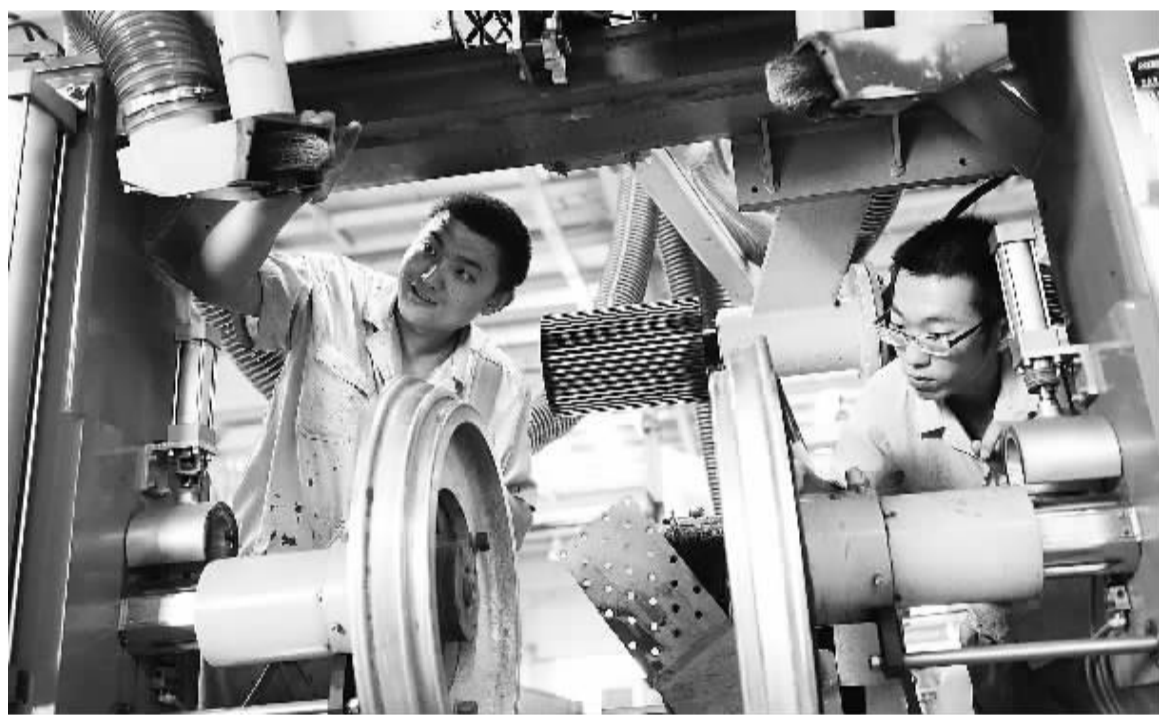
8月16日，青岛万方循环利用环保科技有限公司的员工正在生产车间检修轮胎打磨机和自动贴合机。
