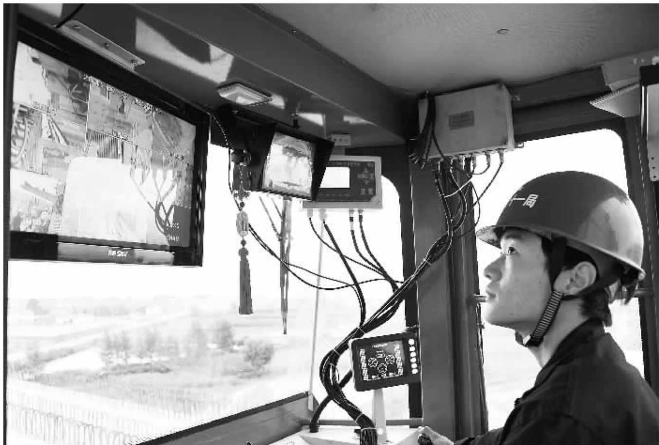
7月27日,中铁十一局一名建设者在操作室内操控SLJ900/32新型无下导梁流动式架桥机在吉图珲铁路客运专线标蛟河特大桥架梁。由中铁十一局集团第六工程公司汉江重工科技公司自行研制这台新型架桥机,可以承担隧道内、隧道口等区段所有复杂工况下的重载双线箱梁、预应力混凝土整孔箱梁的架梁施工,其技术水平居于世界领先地位。新华社记者 杜华举摄
