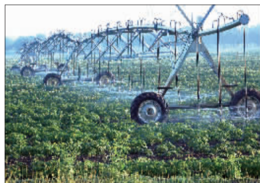
节水设备大型喷灌机正在进行喷灌作业。
