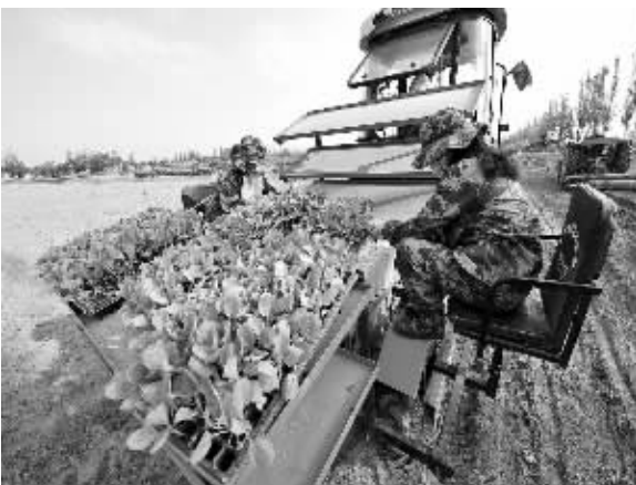
6月29日,在宁夏回族自治区吴忠市一处标准化农田内,蔬菜移栽机正在田里移栽甘蓝种苗。从2011年起,宁夏回族自治区在多地试点示范蔬菜、玉米机械化育苗移栽技术。目前,已完成近千亩的试验示范面积,机械化移栽较人工移栽亩节约成本50元以上,增产5%以上。新华社记者 彭昭之摄
