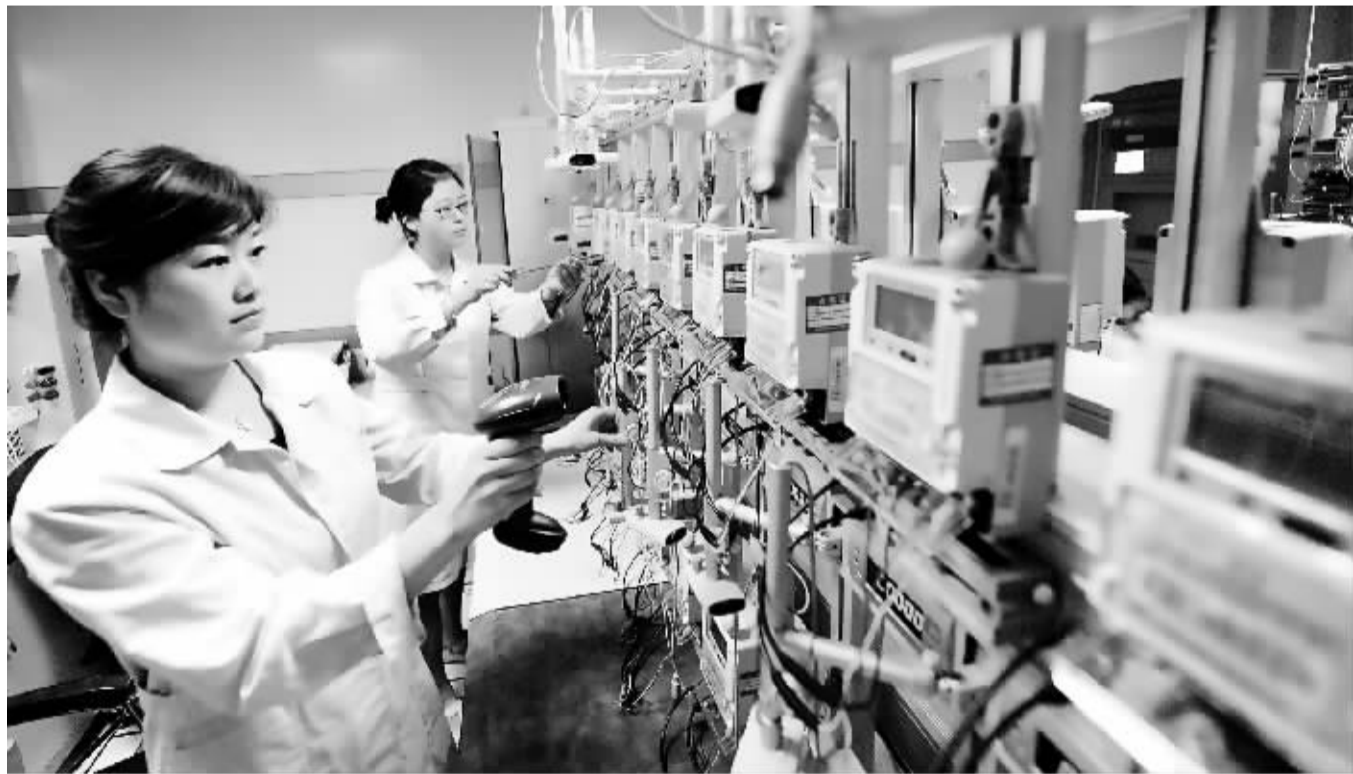
陕西咸阳供电局全面推进智能电表推广应用和用电信息采集系统建设，该公司计划到6月底，完成辖区内智能电表的全面改造，实现用户的“全采集、全覆盖、全费控”。图为公司电能计量中心工作人员正在检定智能电表。 本报记者 赵晶摄
