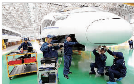
装配车间员工正在进行CRH380CL型动车组第14组EC16车前端总成工序施工。
