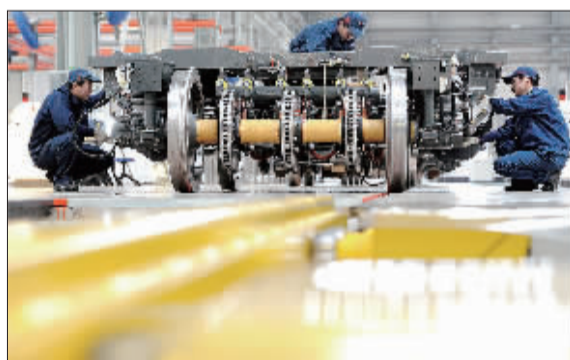
静压调试班的员工正在安装空气簧螺栓和水平减震器。
