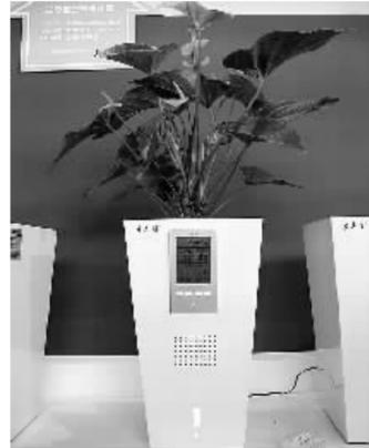
图为北京首创纳米科技有限公司研制的生态型空气净化器。它通过含有特定微生物的土壤来净化空气，有害物质被微生物降解后再被植物吸收，净化效果显著，节能环保。 本报记者 董碧娟摄
