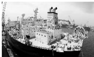
河北山海关船舶重工有限责任公司近日顺利完成存储容量为34万立方米的大型浮式储油卸油船(FSO)的改造工作。该储油卸油船前身是1993年建造的载重30万吨的巨型油轮“北方之珠”，改造前总长334米，改造后总长为387米，存储容量为34万立方米，是集油气储存、外输、装卸、动力供应于一体的高科技海洋平台。图为停靠在码头的大型浮式储油卸油船。 王寒植摄 (新华社发)
