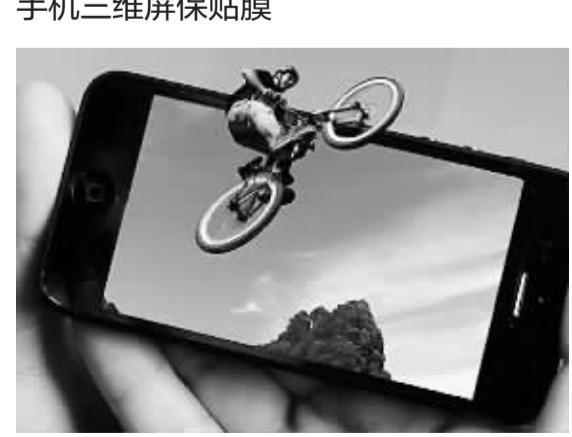
新加坡科学家采用纳米压印技术，研发成功一种三维屏保贴膜，用于智能手机，能使立体视像跃然掌上，将手机屏幕变成了真正无需眼镜的3
