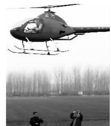
江苏云河飞机有限公司研发的轻型直升飞机“云河号”近日试飞成功。该机为搭载147马力发动机的两座轻型直升飞机,可应用于体育运动飞行、救灾飞行、农作物施肥喷雾、航空拍摄等用途。图为试飞现场。
