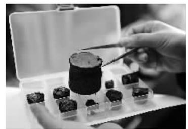
图为浙江大学科学家研制出的“全碳气凝胶”固态材料,其密度仅每立方厘米0.16毫克,是迄今为止世界上最轻的材料。
