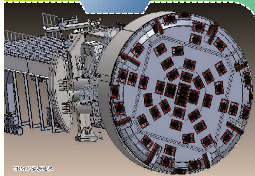
TBM硬岩掘进机
