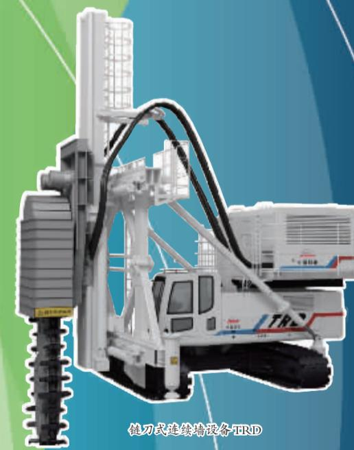
链刀式连续墙设备TRD
