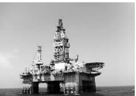
中国首座自主设计、建造的第六代深水半潜式钻井平台“海洋石油981”,在南海正式开钻。
