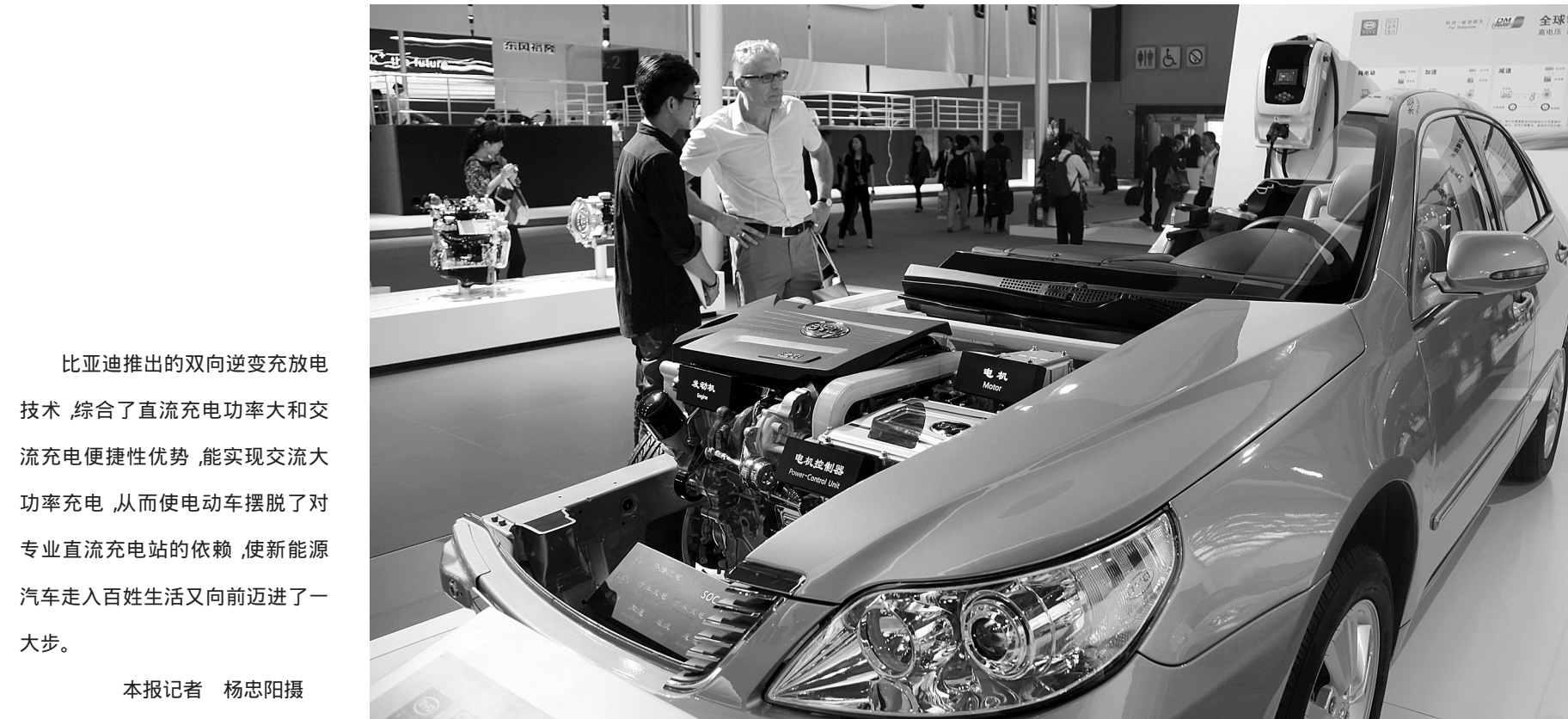
比亚迪推出的双向逆变充放电技术,综合了直流充电功率大和交流充电便捷性优势,能实现交流大功率充电,从而使电动车摆脱了对专业直流充电站的依赖,使新能源汽车走入百姓生活又向前迈进了一大步。
