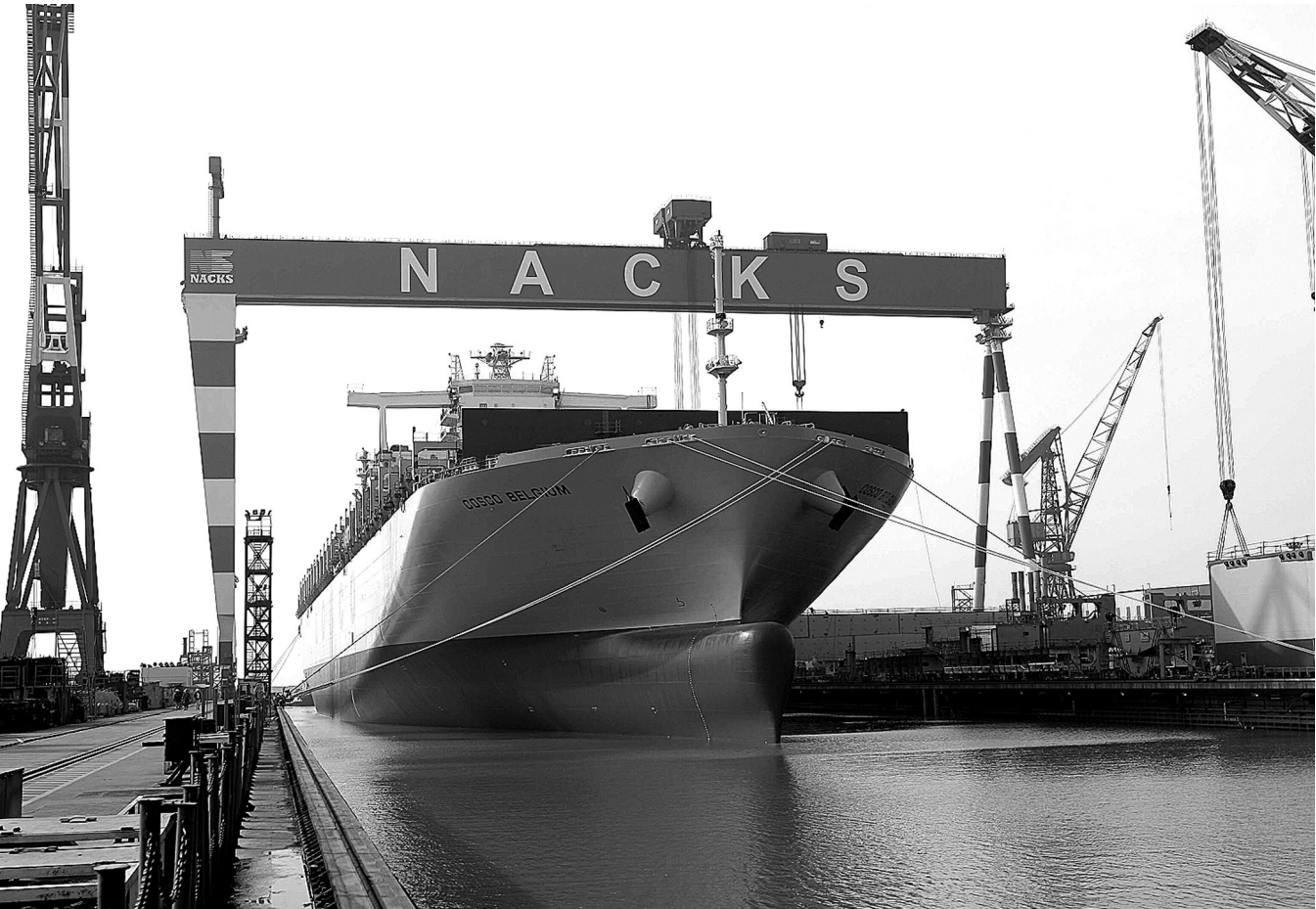
12月10日，南通中远川崎船舶工程有限公司建造的一艘13000标准箱集装箱船在江苏省南通市出坞。该船总长366米，型宽51.2米，总箱位约13000个，具有油耗低、装箱量大、建造精度高、适港性强等优势。 丁晓春摄（新华社发）
