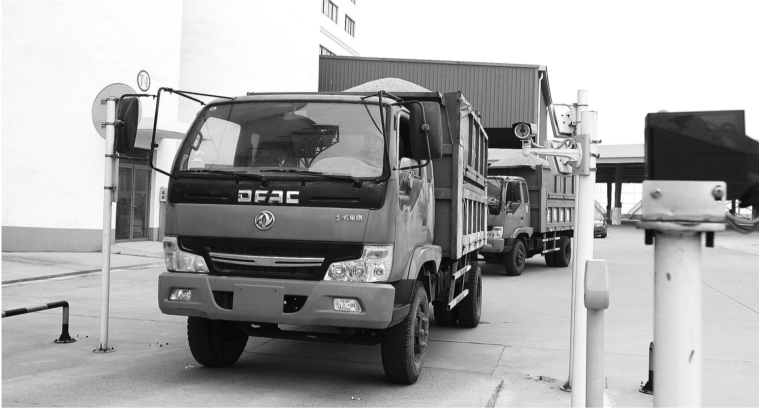
位于无锡粮食科技物流中心的 数字粮库 已初步建成。图为粮库的地磅称重系统。在磅台周围 安装有车辆检测器、传感器、RFID(无线射频识别)读写器、摄像头等多个物联网传感设备和自动控制设备，实现了实时监控和自动化业务流程管理。 本报记者 徐 红摄
