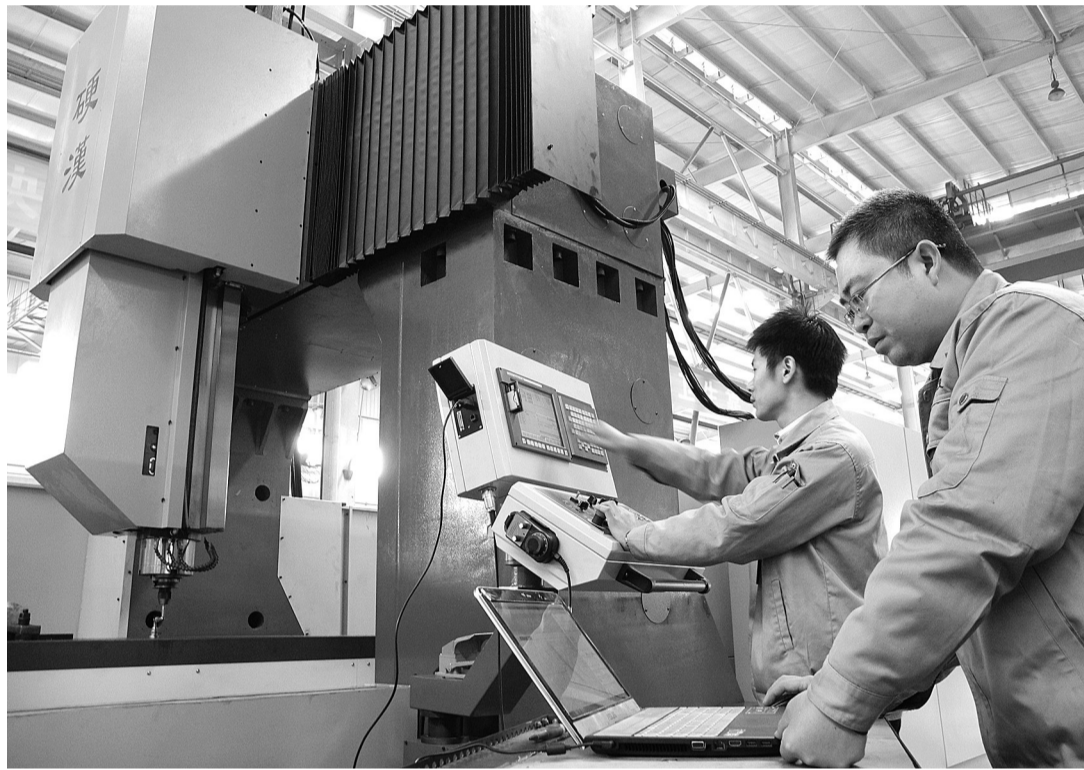
12月5日,由重庆硬汉数控机床有限公司自主研制的DMV系列龙门式切削中心机投产。该产品填补了重庆市精密大型机床制造行业的空白。图为技术人员在装配车间内对大型龙门数控机床进行跑合测试。本报记者 吴陆毅摄
