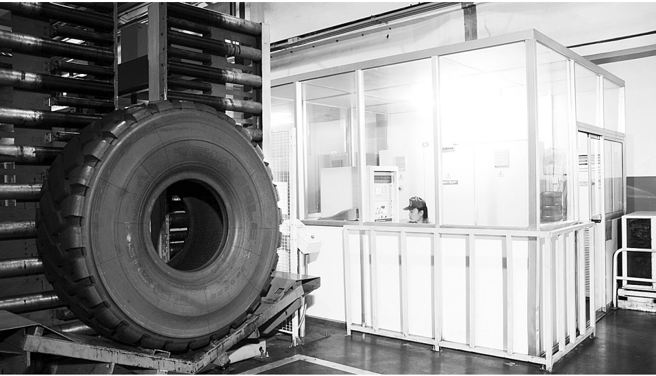
三角集团员工正在使用 x 光检测设备对产品进行严格检测。
