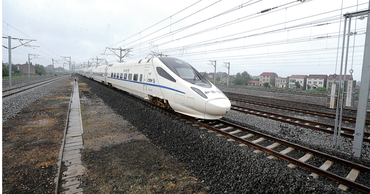
6月27日,一辆高速列车在汉宜铁路上行驶。当日,汉宜铁路客运专线开行方案和列车时刻表正式出炉:从7月1日起汉宜铁路将开行31对列车。汉宜铁路设计时速200公里,以客运为主,兼顾货运,是我国《中长期铁路网规划》中沪汉蓉快速大通道的组成部分。
