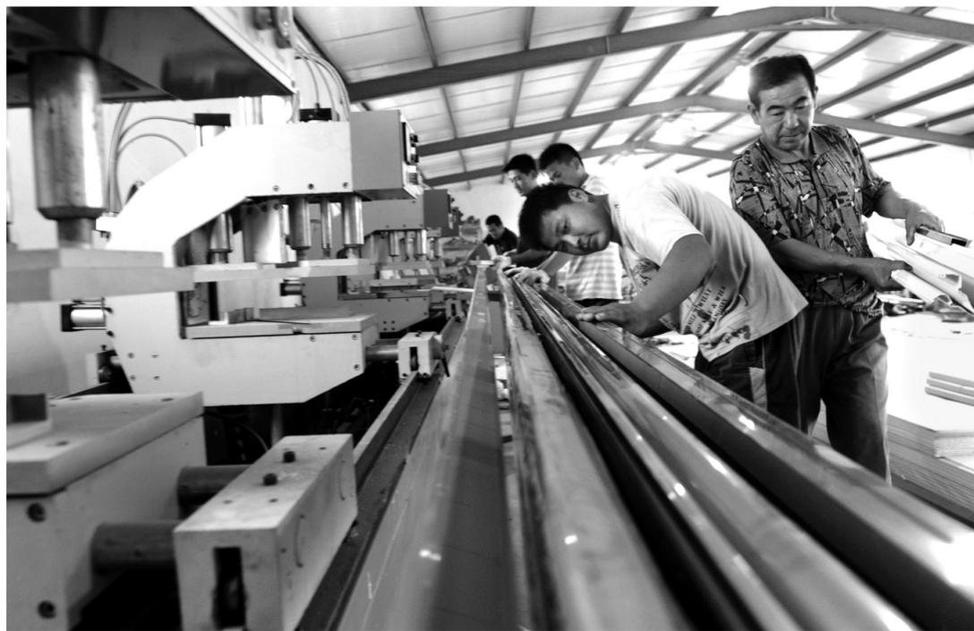
山东沾化县滨海镇金辉塑钢成型厂员工正在加工铝合金门窗。该厂利用先进加工设备和工艺,使业务订单逐年增加,并带动了周边乡镇企业的同步发展。
